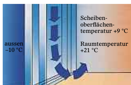
Bei konventionellem Isolierglas bildet sich in Fensternähe ein unangenehmer Kälteschleier.
